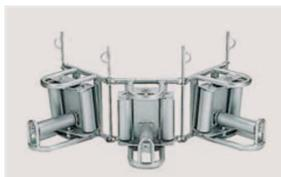
Рисунок 10. Угловой ролик
